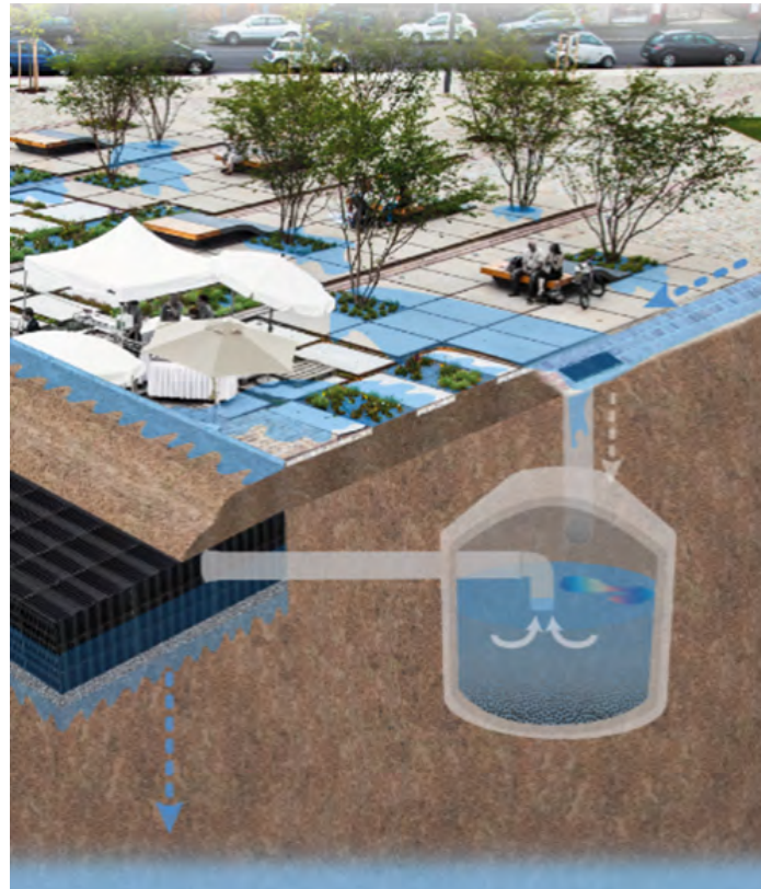
Abb.: Integriertes Regenwasserkonzept – Quelle: Henning Larsen
